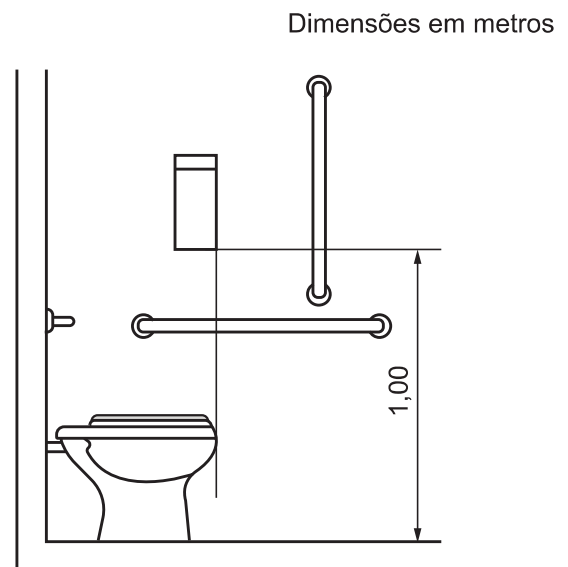
Figura 125 – Localização da papeladeira de sobrepor (interfolhado) – Vista lateral
